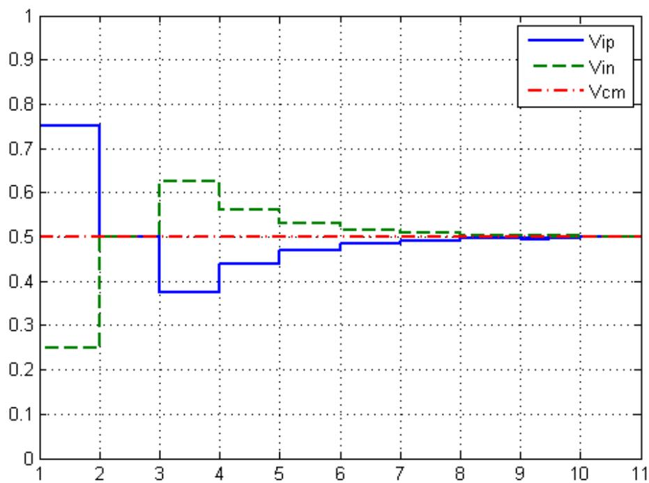
接下来，对 ADC 输出结果进行验证。图中为输入不同差模电压下所得到的数字输出。
