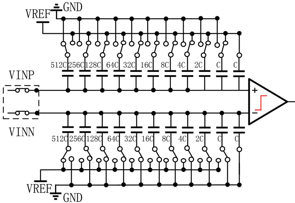
可以看到相较第三种切换方式，前两种的电容所占面积更小。但根据耿文良学长论文中的阐述，前两种切换方式将导致比较器输入端的共模电平发生改变（这在后面的程序实现中也可以看到），从而引入额外的非线性成分，导致 ADC 精度下降。这三种电路的输入范围均为  $-V_{ref}$  至  $+V_{ref}$ ，理论上有 10 比特的精度。
