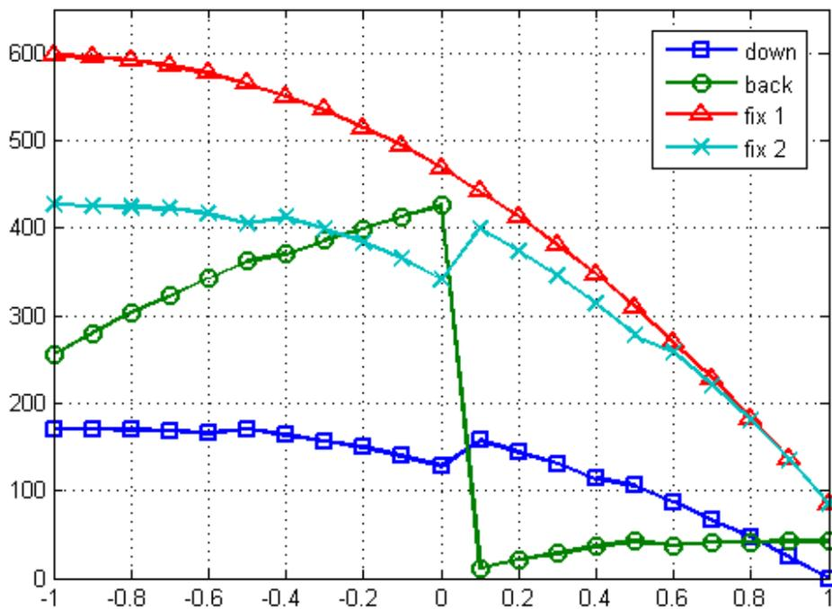
图中，蓝色曲线和绿色曲线为共模电平向下切换式、共模电平收敛切换式两种切换方式。而淡蓝色和红色曲线均为共模电平固定切换式的能耗。可以看见前两种切换方式的确相较于第三种方式有更小的能耗。之所以会有两条共模电平固定切换式的曲线，是因为这种方式在一次比较过程中可能发生两个开关的切换。即  $10 \rightarrow 11 \rightarrow 01$  和  $10 \rightarrow 00 \rightarrow 01$  两种方式（淡蓝色），然后实验验证上述两种方式能耗一致，却与  $10 \rightarrow 01$ （红色）的计算结果不同， $10 \rightarrow 01$  较高。
